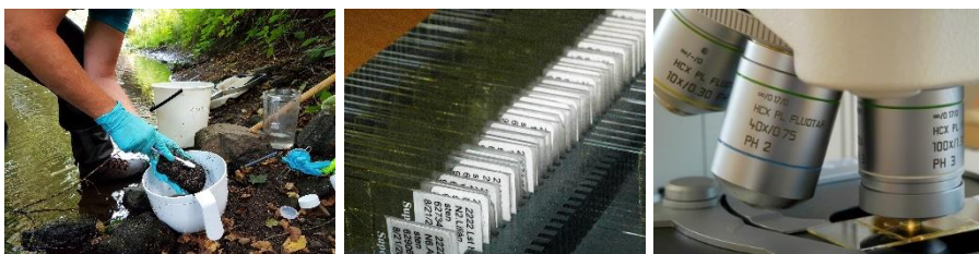
Figur 1. Provtagning av kiselalger görs i första hand från sten och innebär i korthet att minst fem stenar borstas av med en ren tandborste och påväxtmaterialet sköljs ner i en behållare. Stenarna insamlas längs en provtagningssträcka som är representativ för lokalen med avseende på bottensubstrat, vegetation, vattendjup, vattenhastighet och beskuggning. Kiselalgskalen prepareras därefter fram på laboratorium och fixeras på objektglas. Kiselalgsanalys görs i ljusmikroskop i 1000 gångers förstoring med oljeimmersionsobjektiv. Mikroskopet ska helst vara utrustat med interferenskontrast, vilket gör att man kan se mycket små former tydligare än med andra tekniker.
